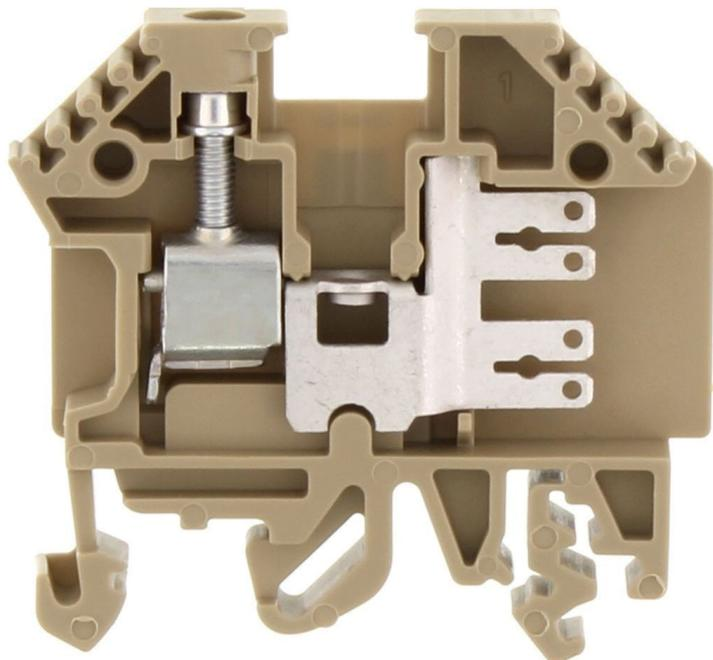
Durchgangsklemme, Faston Flachsteckanschluss / Schraubanschluss, Montageart: TS 35/7,5 und TS 32, Bemessungsquerschnitt: 2,5 mm<sup>2</sup>, Breite: 6 mm, Farbe: Beige
