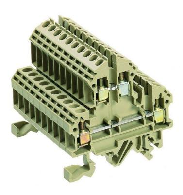
Doppelstockklemme/Blockvariante, Schraubanschluss, Montageart: TS 35/7,5 und TS 32, Bemessungsquerschnitt: 4 mm², Farbe: Beige
