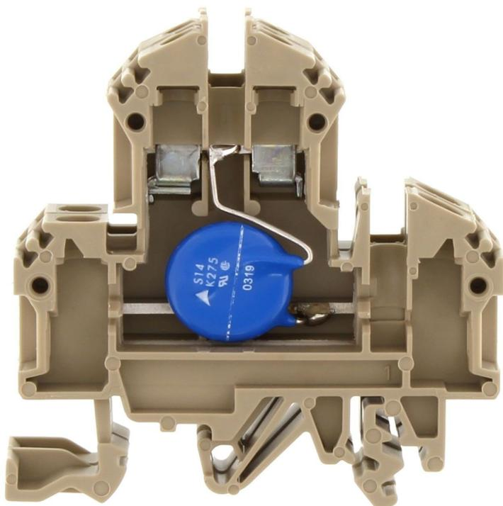
Doppelstockklemme mit elektronischen Bauteilen, Schraubanschluss, Montageart: TS 35/7,5 und TS 32, Bemessungsquerschnitt: 4 mm<sup>2</sup>, Breite: 12 mm, Farbe: Beige
