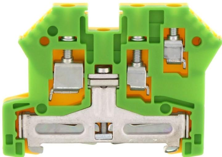
Schutzleiterklemme, Schraubanschluss, Montageart: TS 35/7,5, Bemessungsquerschnitt: 2,5 mm<sup>2</sup>, Breite: 6 mm, Farbe: Grün-gelb
