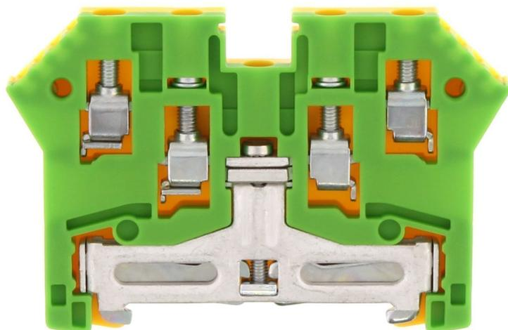
Schutzleiterklemme, Schraubanschluss, Montageart: TS 35/7,5, Bemessungsquerschnitt: 2,5 mm<sup>2</sup>, Breite: 6 mm, Farbe: Grün-gelb
