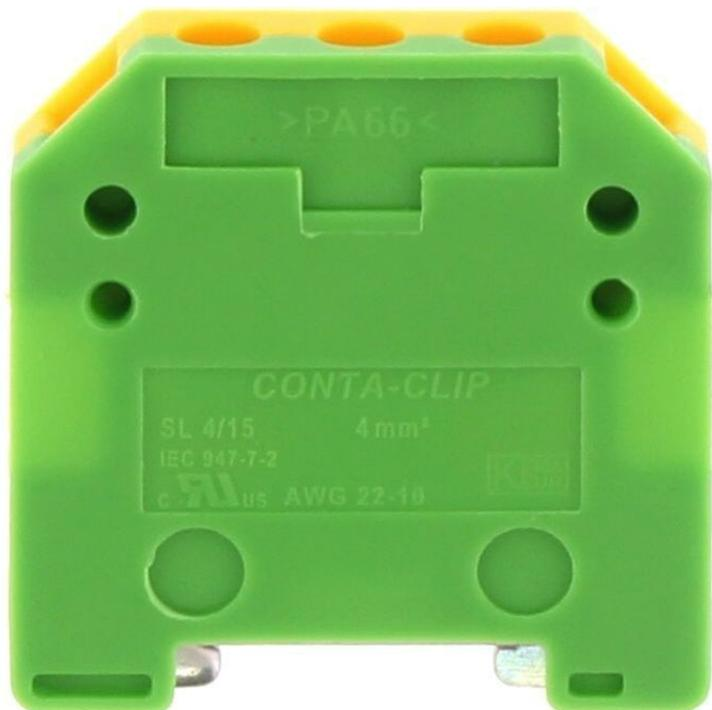
Schutzleiterklemme, Schraubanschluss, Montageart: TS 15/5,5, Bemessungsquerschnitt: 4 mm<sup>2</sup>, Breite: 7 mm, Farbe: Grün-gelb
