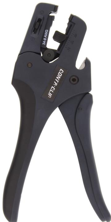
Abisolierwerkzeug für CU- und AL-Leitungen Abisolierbereich: PVC isolierte Leiter von 0,02-10 mm<sup>2</sup> (AWG 34-8) Schneidbereich: bis 10 mm<sup>2</sup> feindrätig (AWG 8)
