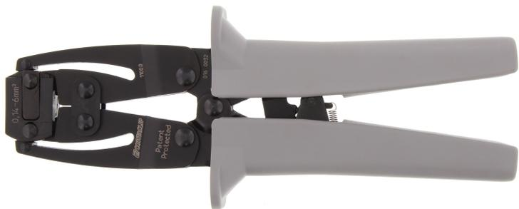
Crimpwerkzeug zum Crimpen von Aderendhülsen mit und ohne Kunststoffkragen. Querschnittsbereich: 0,5-6 mm<sup>2</sup> (AWG 2-10). Leichte Handhabung, Zwangssperre für korrektes vollständiges Crimpen, Leitereinführung von vorne, selbstöffnend durch eingebaute Feder.
