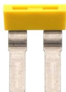
Außenquerverbinder isoliert, Polzahl: 2, Montageart: Stecken, Breite: 18,1 mm, Bemessungsstrom: 57 A, Farbe: Gelb
