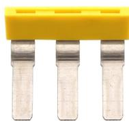
Außenquerverbinder isoliert, Polzahl: 3, Montageart: Stecken, Breite: 28,2 mm, Bemessungsstrom: 57 A, Farbe: Gelb
