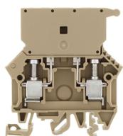
Sicherungstrennklemme, Schraubanschluss, Montageart: TS 35/7,5 und TS 32, Bemessungsquerschnitt: 10 mm<sup>2</sup>, Breite: 8 mm, Farbe: Beige
