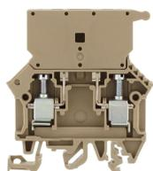
Sicherungsklemme mit Trennstecker, Schraubanschluss, Montageart: TS 35/7,5 und TS 32, Bemessungsquerschnitt: 10 mm<sup>2</sup>, Breite: 8 mm, Farbe: Beige
