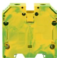
Schutzleiterklemme, Schraubanschluss, Montageart: TS 35/7,5, Bemessungsquerschnitt: 50 mm<sup>2</sup>, Breite: 18,5 mm, Farbe: Grün-gelb
