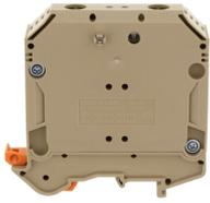
Ex-Durchgangsklemme zertifiziert nach ATEX, Schraubanschluss, Montageart: TS 35/7,5 und TS 32, Bemessungsquerschnitt: 50 mm<sup>2</sup>, Breite: 20 mm, Farbe: Beige
