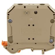
Durchgangsklemme, Schraubanschluss, Montageart: TS 35/7,5 und TS 32, Bemessungsquerschnitt: 50 mm<sup>2</sup>, Breite: 20 mm, Farbe: Beige
