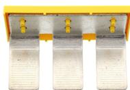
Aussenquerverbinder isoliert, Polzahl: 3, Montageart: Stecken, Breite: 103,12 mm, Bemessungsstrom: 380 A, Farbe: Gelb
