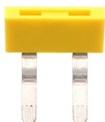
Außenquerverbinder isoliert, Polzahl: 2, Montageart: Stecken, Breite: 16,1 mm, Bemessungsstrom: 27 A, Farbe: Gelb
