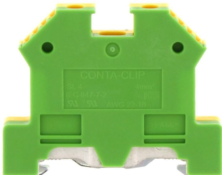
Schutzleiterklemme, Schraubanschluss, Montageart: TS 35/7,5, Bemessungsquerschnitt: 4 mm<sup>2</sup>, Breite: 8 mm, Farbe: Grün-gelb
