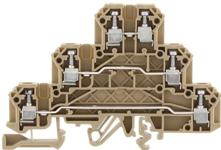
Dreistock-Initiatorenklemme|Mehrleiterklemme, Schraubanschluss, Montageart: TS 35/7,5 und TS 32, Bemessungsquerschnitt: 2,5 mm<sup>2</sup>, Breite: 5 mm, Farbe: Beige
