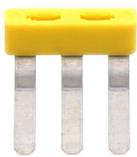
Außenquerverbinder isoliert, Polzahl: 3, Montageart: Stecken, Breite: 14,36 mm, Bemessungsstrom: 27 A, Farbe: Gelb
