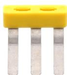
Außenquerverbinder isoliert, Polzahl: 3, Montageart: Stecken, Breite: 14,36 mm, Bemessungsstrom: 27 A, Farbe: Gelb
