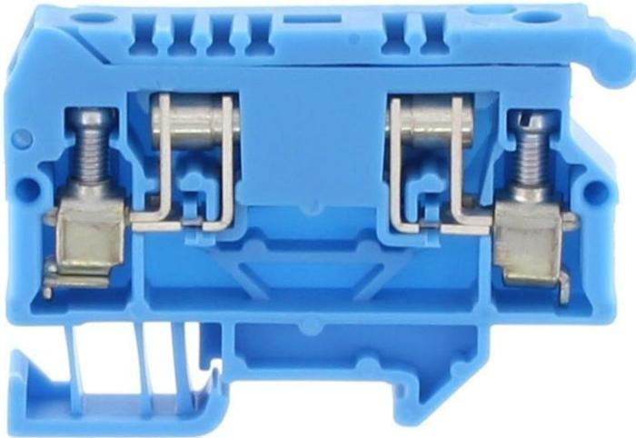
Trennklemme, Schraubanschluss, Montageart: TS 15/5,5, Bemessungsquerschnitt: 4 mm<sup>2</sup>, Breite: 8 mm, Farbe: Blau
