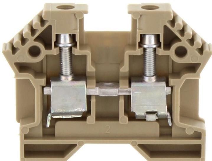
Durchgangsklemme zur Direktmontage/Blockvariante, Schraubanschluss, Montageart: Montagefläche, Bemessungsquerschnitt: 4 mm<sup>2</sup>, Breite: 6 mm, Farbe: Beige
