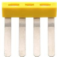
Außenquerverbinder isoliert, Polzahl: 4, Montageart: Stecken, Breite: 23 mm, Bemessungsstrom: 27 A, Farbe: Gelb
