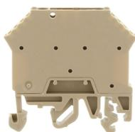
Trennklemme, Schraubanschluss, Montageart: TS 35/7,5 und TS 32, Bemessungsquerschnitt: 2,5 mm<sup>2</sup>, Breite: 6 mm, Farbe: Beige
