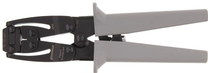
Crimpwerkzeug zum Crimpen von Aderendhülsen mit und ohne Kunststoffkragen. Querschnittsbereich: 10 - 16 mm<sup>2</sup> (AWG 7-6) Leichte Handhabung, Zwangssperre für korrektes vollständiges Crimpen, seitliche Leitereinführung, selbstöffnend durch eingebaute Feder.
