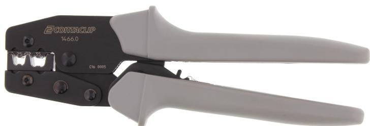
Crimpwerkzeug zum Crimpen von Aderendhülsen mit und ohne Kunststoffkragen. Querschnittsbereich: 25 + 35 mm<sup>2</sup>. Leichte Handhabung, Zwangssperre für korrektes vollständiges Crimpen, seitliche Leitereinführung, selbstöffnend durch eingebaute Feder.
