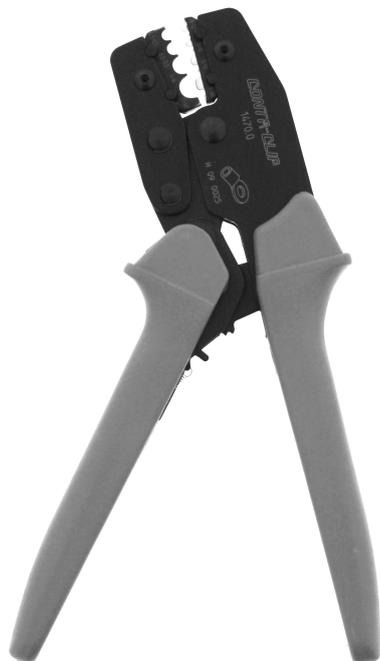
Crimpwerkzeug für nicht isolierte Quetschkabelschuhe in Ring- und Gabelform. Leichte Handhabung, Zwangssperre für korrektes vollständiges Crimpen, seitliche Leitereinführung, selbstöffnend durch eingebaute Feder.
