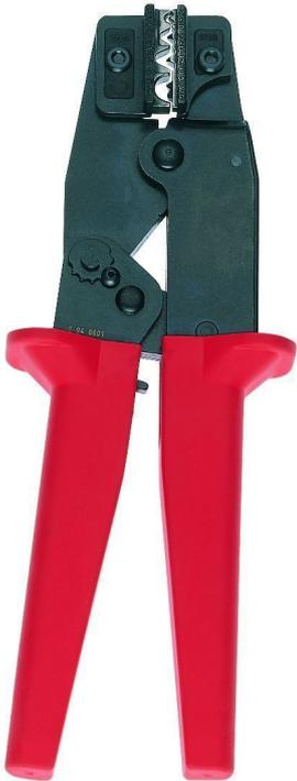
Crimpwerkzeug für nicht isolierte Quetschkabelschuhe in Flachsteckform. Leichte Handhabung, Zwangssperre für korrektes vollständiges Crimpen, seitliche Leitereinführung, selbstöffnend durch eingebaute Feder.
