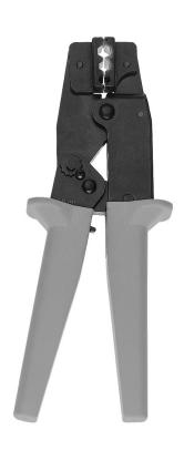
Crimpwerkzeug für COAX Steckverbinder BNC/TNC, (Kabeltypen RG 58, 59, 62 und 71). Leichte Handhabung, Zwangssperre für korrektes vollständiges Crimpen, seitliche Leitereinführung, selbstöffnend durch eingebaute Feder. Hochwertige Industrieausführung.
