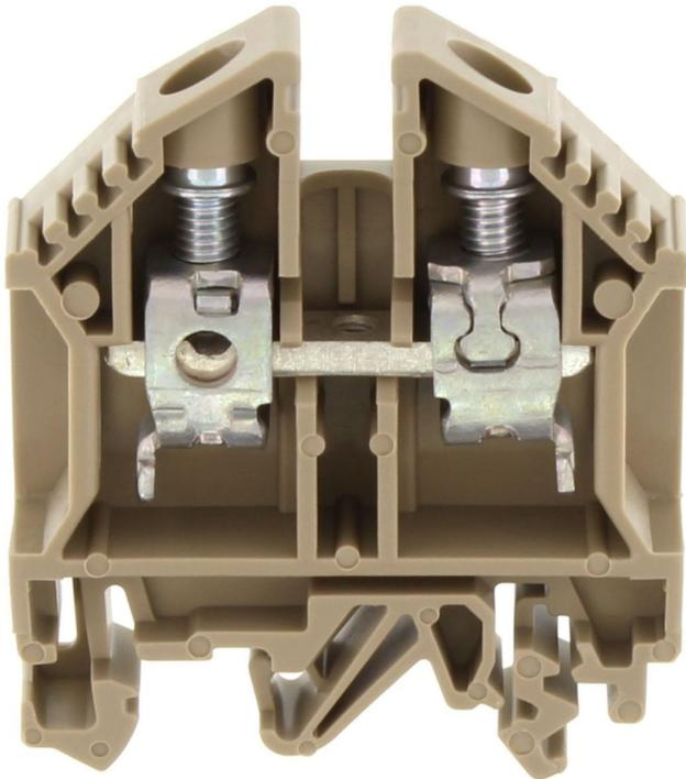
Durchgangsklemme, Schraubanschluss, Montageart: TS 35/7,5 und TS 32, Bemessungsquerschnitt: 16 mm<sup>2</sup>, Breite: 12 mm, Farbe: Beige
