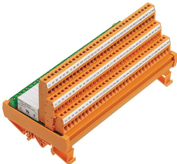
Mehrfach-Relaismodul, Schraubanschluss, mit 8 Miniaturrelais, je 1 Wechsler, eingelötet, mit Leuchtanzeige, minusschaltend, Eingangsspannung: 24 VDC
