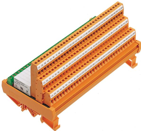
Mehrfach-Relaismodul, Schraubanschluss, mit 16 Miniaturrelais, je 1 Wechsler, eingelötet, mit Leuchtanzeige, getrennte Kanäle, Eingangsspannung: 24 VAC/DC
