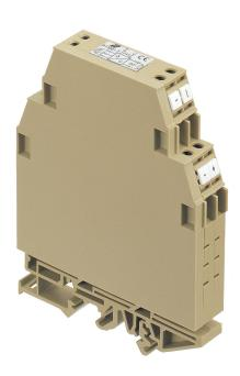
Signalwandler für den Anschluss von PT 100 Thermosenoren auf ein analoges Normsignal, Schraubanschluss, Montageart: TS 35, Versorgungsspannung: 24 VDC
