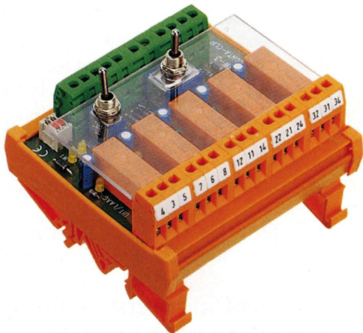
Digitales Schaltmodul mit Hand-Aus-Automatik Umschaltung, mit Rückmeldeschleife und Watchdog, Schraubanschluss, Montageart: TS 35, Spannung: 24VAC/DC
