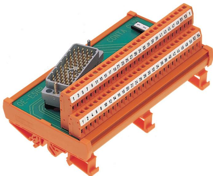
Übergabemodul für EDAC, Schraubanschluss und EDAC(elco)-Steckverbinder, Montageart: TS 35, Polzahl: 56
