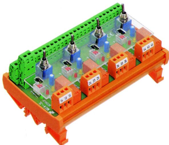
Digitales Schaltmodul mit Hand-Aus-Automatik Umschaltung, mit Rückmeldeschleife und Watchdog, Schraubanschluss, Montageart: TS 35, 4 Kanäle, Spannung: 24VAC/DC
