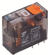
Steckbare Industrirelais mit Leistungskontakten, 2 Wechsler, Prüftaste, Status-LED, mechanische Schaltstellungsanzeige, Eingangsspannung: 230 VAC
