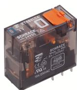
Steckbare Industrieries mit Leistungskontakten, 1 Wechsler, Prüftaste, Status-LED, mechanische Schaltstellungsanzeige, Eingangsspannung: 230 VAC
