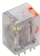
Steckbare Industrirelais mit Leistungskontakten, 2 Wechsler, Prüftaste, Status-LED, Freilaufdiode, mechanische Schaltstellungsanzeige, Polarität A1+, A2-, Eingangsspannung: 24 VDC
