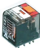
Steckbare Industrirelais, mit Mehrlagen-Goldkontakt, 4 Wechsler, Prüftaste, mechanische Schaltstellungsanzeige, Polarität A1+, A2-, Eingangsspannung: 24 VDC
