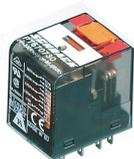
Steckbare Industrirelais mit Leistungskontakten, 4 Wechsler, Prüftaste, mechanische Schaltstellungsanzeige, Eingangsspannung: 12 VAC
