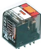
Steckbare Industrirelais mit Leistungskontakten, 4 Wechsler, Prüftaste, mechanische Schaltstellungsanzeige, Polarität A1+, A2-, Eingangsspannung: 60 VDC
