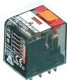
Steckbare Industrirelais mit Leistungskontakten, 4 Wechsler, Prüftaste, mechanische Schaltstellungsanzeige, Polarität A1+, A2-, Eingangsspannung: 110 VDC
