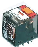
Steckbare Industrirelais mit Leistungskontakten, 4 Wechsler, Prüftaste, mechanische Schaltstellungsanzeige, Eingangsspannung: 115 VAC
