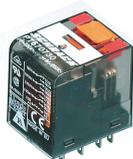
Steckbare Industrirelais mit Leistungskontakten, 4 Wechsler, Prüftaste, mechanische Schaltstellungsanzeige, Eingangsspannung: 24 VAC
