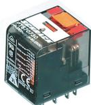
Steckbare Industrirelais mit Leistungskontakten, 4 Wechsler, Prüftaste, mechanische Schaltstellungsanzeige, Polarität A1+, A2-, Eingangsspannung: 220 VDC
