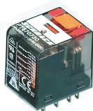
Steckbare Industrirelais mit Leistungskontakten, 4 Wechsler, Prüftaste, mechanische Schaltstellungsanzeige, Polarität A1+, A2-, Eingangsspannung: 24 VDC
