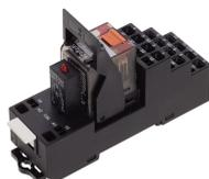
Vormontiertes Relaismodul PRS..., Zugfederanschluss, bestehend aus: Relaissockel, Leistungskontaktrelais, steckbarem Anzeige-/ Entstörm modul und Haltebügel, 4 Wechsler, Eingangsspannung: 60 VDC
