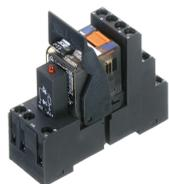
Vormontiertes Relaismodul PRS..., Schraubanschluss, bestehend aus: Relaissockel, Leistungskontaktrelais, steckbarem Anzeige-/ Entstörm modul und Haltebügel, 4 Wechsler, Eingangsspannung: 12 VAC
