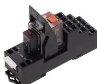
Vormontiertes Relaismodul PRS..., Zugfederanschluss, bestehend aus: Relaissockel, Leistungskontaktrelais, steckbarem Anzeige-/ Entstörm modul und Haltebügel, 4 Wechsler, Eingangsspannung: 12 VDC
