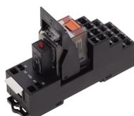
Vormontiertes Relaismodul PRS..., Zugfederanschluss, bestehend aus: Relaissockel, Leistungskontaktrelais, steckbarem Anzeige-/ Entstörm modul und Haltebügel, 4 Wechsler, Eingangsspannung: 230 VAC
