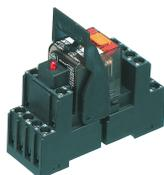
Vormontiertes Relaismodul PRS..., Schraubanschluss, bestehend aus: Relaissockel, Leistungskontaktrelais, steckbarem Anzeige-/ Entstörm modul und Haltebügel, 4 Wechsler, Eingangsspannung: 12 VAC
