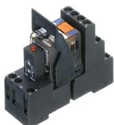
Vormontiertes Relaismodul PRS..., Schraubanschluss, bestehend aus: Relaissockel, Leistungskontaktrelais, steckbarem Anzeige-/ Entstörmodul und Haltebügel, 4 Wechsler, Eingangsspannung: 220 VDC
