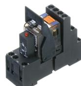
Vormontiertes Relaismodul PRS..., Schraubanschluss, bestehend aus: Relaissockel, Leistungskontaktrelais, steckbarem Anzeige-/ Entstörmodul und Haltebügel, 4 Wechsler, Eingangsspannung: 24 VDC
