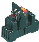
Vormontiertes Relaismodul PRS..., Schraubanschluss, bestehend aus: Relaissockel, Leistungskontaktrelais, steckbarem Anzeige-/ Entstörmodul und Haltebügel, 4 Wechsler, Eingangsspannung: 230 VAC
