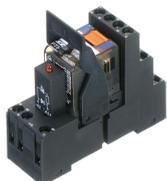
Vormontiertes Relaismodul PRS..., Schraubanschluss, bestehend aus: Relaissockel, Leistungskontaktrelais, steckbarem Anzeige-/ Entstörmodul und Haltebügel, 4 Wechsler, Eingangsspannung: 110 VDC
