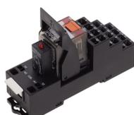
Vormontiertes Relaismodul PRS..., Zugfederanschluss, bestehend aus: Relaissockel, Leistungskontaktrelais, steckbarem Anzeige-/ Entstörm modul und Haltebügel, 4 Wechsler, Eingangsspannung: 115 VAC
