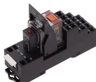
Vormontiertes Relaismodul PRS..., Zugfederanschluss, bestehend aus: Relaissockel, Leistungskontaktrelais, steckbarem Anzeige-/ Entstörm modul und Haltebügel, 4 Wechsler, Eingangsspannung: 110 VDC
