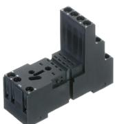
Relais-Stecksocket PRS, für Industrierelais mit 4-Wechslern, Schraubanschluss, Steckmöglichkeit für Eingangs-/Entstörmodule, Montageart: TS 35
