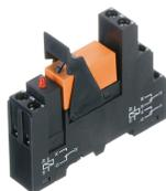
Vormontiertes Relaismodul PRS..., Schraubanschluss, bestehend aus: Relaissockel, Leistungskontaktrelais, steckbarem Anzeige-/ Entstörmodul und Haltebügel, 2 Wechsler, Eingangsspannung: 24 VDC
