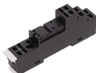
Relais-Stecksockel PRS, für Miniatur-Leistungserelais mit 1-Wechsler, Zugfederanschluss, Steckmöglichkeit für Eingangs-/Entstörmodule, Montageart: TS 35
