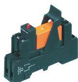
Vormontiertes Relaismodul PRS..., Schraubanschluss, bestehend aus: Relaissockel, Leistungskontaktrelais, steckbarem Anzeige-/ Entstörm modul und Haltebügel, 1 Wechsler, Eingangsspannung: 5 VDC
