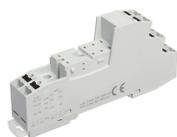
Relais-Stecksocket PRS, für Miniatur-Leistungserelais mit 2-Wechslern, Push-in Anschluss, Steckmöglichkeit für Eingangs-/Entstörm module und Querverbinder, Montageart: TS 35, Bemessungsquerschnitt: 1,5mm<sup>2</sup>, Bemessungsspannung 300V
