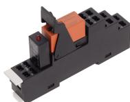
Vormontiertes Relaismodul PRS..., Zugfederanschluss, bestehend aus: Relaissockel, Leistungskontaktrelais, steckbarem Anzeige-/ Entstörmodul und Haltebügel, 1 Wechsler, Eingangsspannung: 24 VDC
