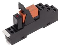
Vormontiertes Relaismodul PRS..., Zugfederanschluss, bestehend aus: Relaissockel, Leistungskontaktrelais, steckbarem Anzeige-/ Entstörm modul und Haltebügel, 1 Wechsler, Eingangsspannung: 12 VDC
