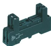
Relais-Stecksockel PRS, für Miniatur-Leistungserelais mit 1-Wechsler, Schraubanschluss, Steckmöglichkeit für Eingangs-/Entstörmodule, Montageart: TS 35
