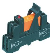
Vormontiertes Relaismodul PRS..., Schraubanschluss, bestehend aus: Relaissockel, Leistungskontaktrelais, steckbarem Anzeige-/ Entstörmodul und Haltebügel, 2 Wechsler, Eingangsspannung: 24 VDC
