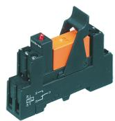
Vormontiertes Relaismodul PRS..., Schraubanschluss, bestehend aus: Relaissockel, Leistungskontaktrelais, steckbarem Anzeige-/ Entstörmodul und Haltebügel, 1 Wechsler, Eingangsspannung: 5 VDC
