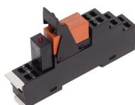
Vormontiertes Relaismodul PRS..., Zugfederanschluss, bestehend aus: Relaissockel, Leistungskontaktrelais, steckbarem Anzeige-/ Entstörm modul und Haltebügel, 1 Wechsler, Eingangsspannung: 24 VDC
