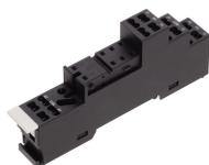
Relais-Stecksocket PRS, für Miniatur-Leistungserelais mit 2-Wechsler, Zugfederanschluss, Steckmöglichkeit für Eingangs-/Entstörmodule, Montageart: TS 35
