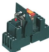
Vormontiertes Relaismodul PRS..., Schraubanschluss, bestehend aus: Relaissockel, Relais mit Mehrlagen-Goldkontakt, steckbarem Anzeige-/ Entstörmodul und Haltebügel, 4 Wechsler, Eingangsspannung: 24 VDC
