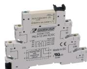
Plug-Relais-Compact (PRC) Komplett, bestehend aus Sockel PRC... mit Schraubanschluss und steckbarem Miniaturrelais PRC... mit Mehrlagen-Goldkontakt, Montageart: TS 35, 1 Wechsler, Eingangsspannung: 24 VDC
