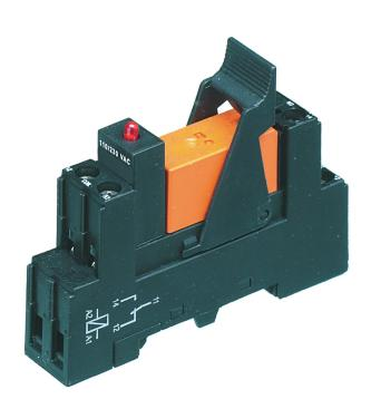
Vormontiertes Relaismodul PRS..., Schraubanschluss, bestehend aus: Relaissockel, Leistungskontaktrelais, steckbarem Anzeige-/ Entstörmodul und Haltebügel, 1 Wechsler, Eingangsspannung: 24 VAC
