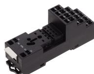
Relais-Stecksockel PRS, für Industrirelais mit 4-Wechslern, Zugfederanschluss, Steckmöglichkeit für Eingangs-/Entstörmodule, Montageart: TS 35
