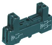
Relais-Stecksockel PRS, für Miniatur-Leistungserlais mit 2-Wechslern, Schraubanschluss, Steckmöglichkeit für Eingangs-/Entstörmodule, Montageart: TS 35
