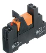
Vormontiertes Relaismodul PRS..., Schraubanschluss, bestehend aus: Relaissockel, Leistungskontaktrelais, steckbarem Anzeige-/ Entstörmodul und Haltebügel, 2 Wechsler, Eingangsspannung: 48 VDC
