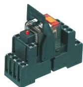
Vormontiertes Relaismodul PRS..., Schraubanschluss, bestehend aus: Relaissockel, Leistungskontaktrelais, steckbarem Anzeige-/ Entstörmodul und Haltebügel, 4 Wechsler, Eingangsspannung: 48 VDC
