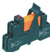
Vormontiertes Relaismodul PRS..., Schraubanschluss, bestehend aus: Relaissockel, Leistungskontaktrelais, steckbarem Anzeige-/ Entstörmodul und Haltebügel, 2 Wechsler, Eingangsspannung: 48 VDC
