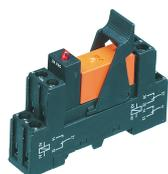
Vormontiertes Relaismodul PRS..., Schraubanschluss, bestehend aus: Relaissockel, Leistungskontaktrelais, steckbarem Anzeige-/ Entstörmodul und Haltebügel, 2 Wechsler, Eingangsspannung: 24 VAC
