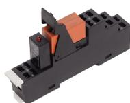
Vormontiertes Relaismodul PRS..., Zugfederanschluss, bestehend aus: Relaissockel, Leistungskontaktrelais, steckbarem Anzeige-/ Entstörmodul und Haltebügel, 2 Wechsler, Eingangsspannung: 24 VAC
