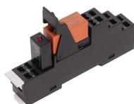
Vormontiertes Relaismodul PRS..., Zugfederanschluss, bestehend aus: Relaissockel, Leistungskontaktrelais, steckbarem Anzeige-/ Entstörmodul und Haltebügel, 2 Wechsler, Eingangsspannung: 48 VDC
