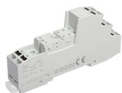
Relais-Stecksockel PRS, für Miniatur-Leistungserlais mit 2-Wechsler, Push-in Anschluss, Steckmöglichkeit für Eingangs-/Entstörm module und Querverbinder, Montageart: TS 35, Bemessungsquerschnitt: 1,5mm<sup>2</sup>, Bemessungsspannung 300V
