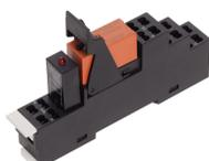
Vormontiertes Relaismodul PRS..., Zugfederanschluss, bestehend aus: Relaissockel, Leistungskontaktrelais, steckbarem Anzeige-/Entstörmodul und Haltebügel, 2 Wechsler, Eingangsspannung: 110 VDC
