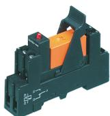
Vormontiertes Relaismodul PRS..., Schraubanschluss, bestehend aus: Relaissockel, Leistungskontaktrelais, steckbarem Anzeige-/Entstörmodul und Haltebügel, 1 Wechsler, Eingangsspannung: 24 VAC
