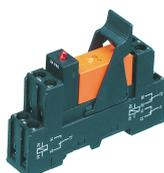
Vormontiertes Relaismodul PRS..., Schraubanschluss, bestehend aus: Relaissockel, Leistungskontaktrelais, steckbarem Anzeige-/ Entstörmodul und Haltebügel, 2 Wechsler, Eingangsspannung: 48 VAC
