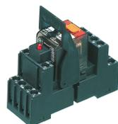
Vormontiertes Relaismodul PRS..., Schraubanschluss, bestehend aus: Relaissockel, Leistungskontaktrelais, steckbarem Anzeige-/ Entstörmodul und Haltebügel, 4 Wechsler, Eingangsspannung: 12 VAC
