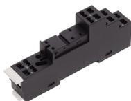
Relais-Stecksockel PRS, für Miniatur-Leistungserelais mit 1-Wechsler, Zugfederanschluss, Steckmöglichkeit für Eingangs-/Entstörmodule, Montageart: TS 35
