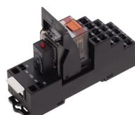
Vormontiertes Relaismodul PRS..., Zugfederanschluss, bestehend aus: Relaissockel, Leistungskontaktrelais, steckbarem Anzeige-/ Entstörmodul und Haltebügel, 4 Wechsler, Eingangsspannung: 24 VAC
