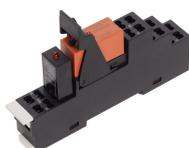
Vormontiertes Relaismodul PRS..., Zugfederanschluss, bestehend aus: Relaissockel, Leistungskontaktrelais, steckbarem Anzeige-/Entstörmodul und Haltebügel, 1 Wechsler, Eingangsspannung: 110 VDC
