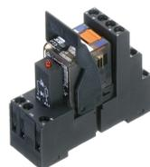
Vormontiertes Relaismodul PRS..., Schraubanschluss, bestehend aus: Relaissockel, Leistungskontaktrelais, steckbarem Anzeige-/ Entstörmodul und Haltebügel, 4 Wechsler, Eingangsspannung: 24 VAC
