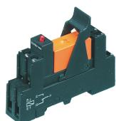
Vormontiertes Relaismodul PRS..., Schraubanschluss, bestehend aus: Relaissockel, Leistungskontaktrelais, steckbarem Anzeige-/ Entstörm modul und Haltebügel, 1 Wechsler, Eingangsspannung: 110 VDC
