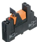
Vormontiertes Relaismodul PRS..., Schraubanschluss, bestehend aus: Relaissockel, Leistungskontaktrelais, steckbarem Anzeige-/Entstörmodul und Haltebügel, 2 Wechsler, Eingangsspannung: 110 VDC
