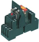
Vormontiertes Relaismodul PRS..., Schraubanschluss, bestehend aus: Relaissockel, Leistungskontaktrelais, steckbarem Anzeige-/ Entstörm modul und Haltebügel, 4 Wechsler, Eingangsspannung: 48 VDC
