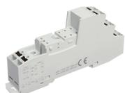
Relais-Stecksockel PRS, für Miniatur-Leistungserlais mit 2-Wechsler, Push-in Anschluss, Steckmöglichkeit für Eingangs-/Entstörm module und Querverbinder, Montageart: TS 35, Bemessungsquerschnitt: 1,5mm<sup>2</sup>, Bemessungsspannung 300V
