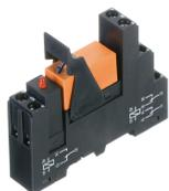
Vormontiertes Relaismodul PRS..., Schraubanschluss, bestehend aus: Relaissockel, Leistungskontaktrelais, steckbarem Anzeige-/ Entstörmodul und Haltebügel, 2 Wechsler, Eingangsspannung: 48 VAC
