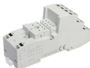
Relais-Stecksockel PRS, für Industrierelais mit 4-Wechsler, Push-in Anschluss, Steckmöglichkeit für Eingangs-/Entstörm module und Querverbinder, Montageart: TS 35
