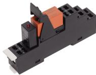
Vormontiertes Relaismodul PRS..., Zugfederanschluss, bestehend aus: Relaissocket, Leistungskontaktrelais, steckbarem Anzeige-/ Entstörmodul und Haltebügel, 1 Wechsler, Eingangsspannung: 115 VAC
