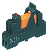
Vormontiertes Relaismodul PRS..., Schraubanschluss, bestehend aus: Relaissocket, Leistungskontaktrelais, steckbarem Anzeige-/ Entstörmodul und Haltebügel, 1 Wechsler, Eingangsspannung: 115 VAC
