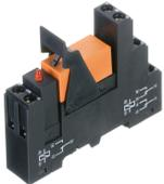
Vormontiertes Relaismodul PRS..., Schraubanschluss, bestehend aus: Relaissockel, Leistungskontaktrelais, steckbarem Anzeige-/Entstörmodul und Haltebügel, 2 Wechsler, Eingangsspannung: 115 VAC
