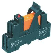
Vormontiertes Relaismodul PRS..., Schraubanschluss, bestehend aus: Relaissockel, Leistungskontaktrelais, steckbarem Anzeige-/Entstörmodul und Haltebügel, 2 Wechsler, Eingangsspannung: 115 VAC
