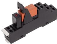
Vormontiertes Relaismodul PRS..., Zugfederanschluss, bestehend aus: Relaissockel, Leistungskontaktrelais, steckbarem Anzeige-/Entstörmodul und Haltebügel, 2 Wechsler, Eingangsspannung: 115 VAC
