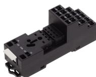
Relais-Stecksocket PRS, für Industrirelais mit 4-Wechslern, Zugfederanschluss, Steckmöglichkeit für Eingangs-/Entstörmodule, Montageart: TS 35
