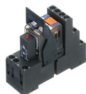
Vormontiertes Relaismodul PRS..., Schraubanschluss, bestehend aus: Relaissocket, Leistungskontaktrelais, steckbarem Anzeige-/ Entstörmodul und Haltebügel, 4 Wechsler, Eingangsspannung: 115 VAC
