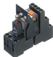
Vormontiertes Relaismodul PRS..., Schraubanschluss, bestehend aus: Relaissocket, Leistungskontaktrelais, steckbarem Anzeige-/ Entstörmodul und Haltebügel, 4 Wechsler, Eingangsspannung: 115 VAC
