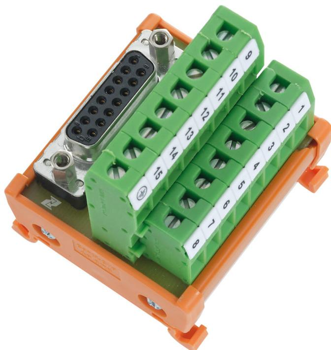
Übergabemodul für D-SUB, Schraubanschluss und female D-SUB-Steckverbinder, Montageart: TS 35, Polzahl: 9
