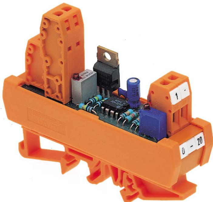
Signalwandler zur Umwandlung von Spannungs/Stromsignalen auf ein analoges Normsignal, Schraubanschluss, Montageart: TS 35, Versorgungsspannung: 24 VDC
