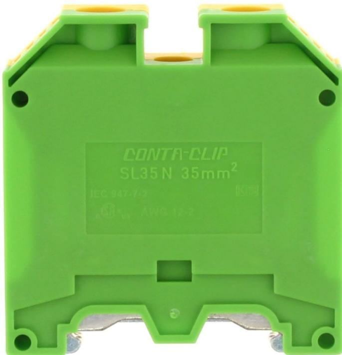
Schutzleiterklemme, Schraubanschluss, Montageart: TS 35/7,5, Bemessungsquerschnitt: 35 mm<sup>2</sup>, Breite: 16 mm, Farbe: Grün-gelb
