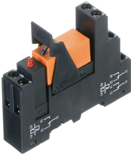
Vormontiertes Relaismodul PRS..., Schraubanschluss, bestehend aus: Relaissockel, Leistungskontaktrelais, steckbarem Anzeige-/ Entstörmodul und Haltebügel, 2 Wechsler, Eingangsspannung: 24 VAC
