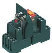
Vormontiertes Relaismodul PRS..., Schraubanschluss, bestehend aus: Relaissocket, Leistungskontaktrelais, steckbarem Anzeige-/ Entstörmodul und Haltebügel, 4 Wechsler, Eingangsspannung: 12 VAC
