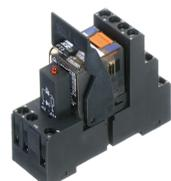
Vormontiertes Relaismodul PRS..., Schraubanschluss, bestehend aus: Relaissocket, Leistungskontaktrelais, steckbarem Anzeige-/ Entstörmodul und Haltebügel, 4 Wechsler, Eingangsspannung: 12 VAC
