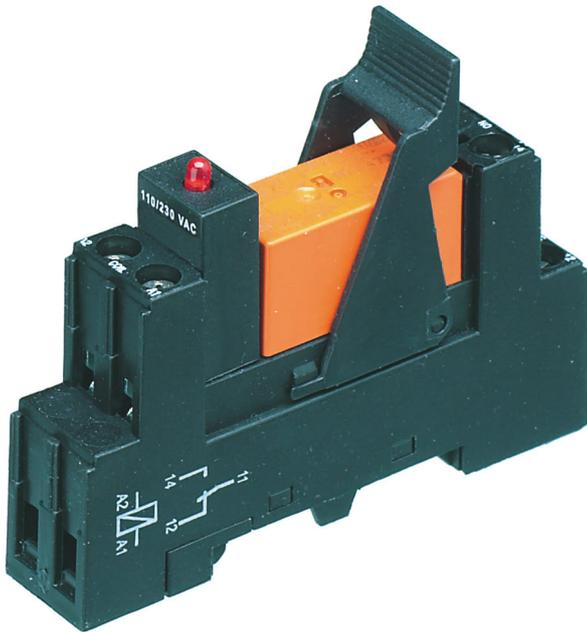
Vormontiertes Relaismodul PRS..., Schraubanschluss, bestehend aus: Relaissockel, Leistungskontaktrelais, steckbarem Anzeige-/ Entstörmodul und Haltebügel, 1 Wechsler, Eingangsspannung: 24 VDC
