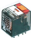
Steckbare Industrirelais mit Leistungskontakten, 4 Wechsler, Prüftaste, mechanische Schaltstellungsanzeige, Polarität A1+, A2-, Eingangsspannung: 12 VDC
