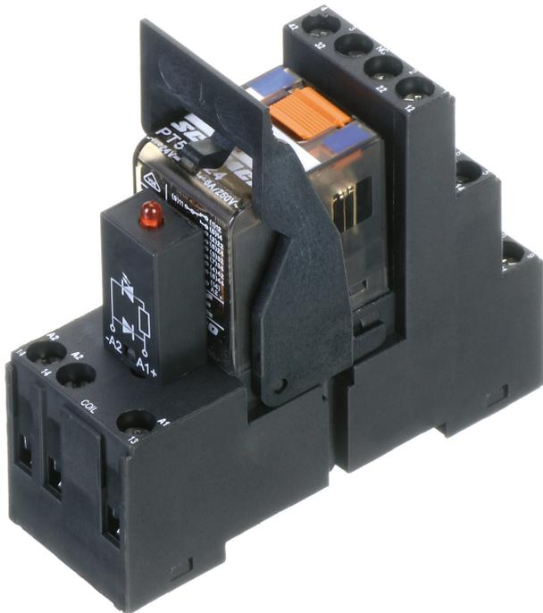
Vormontiertes Relaismodul PRS..., Schraubanschluss, bestehend aus: Relaissockel, Leistungskontaktrelais, steckbarem Anzeige-/ Entstörmodul und Haltebügel, 4 Wechsler, Eingangsspannung: 12 VDC
